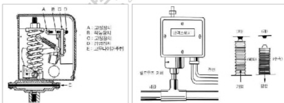
【압력스위치의 구조 및 작동 예시(스프링타입, 벨로우즈 타입)】
