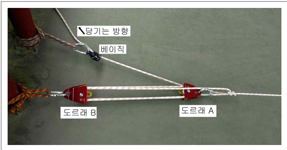
[그림 3-61] 2단 도르래를 이용한 로프 연장 방법
