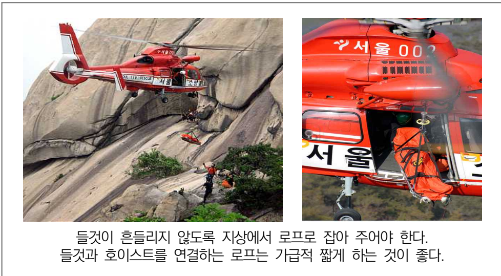
[그림 5-97] 호이스트를 이용한 하강
